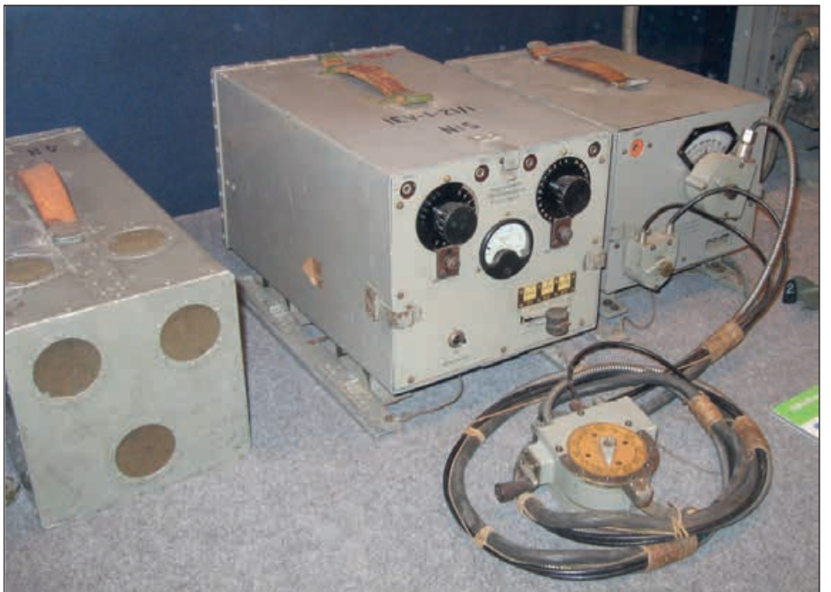
Ensimmäisessä kotimaisessa hävittäjäasemassa P-12-17 oli kolme kidekanavaa ja jatkuvasäätöinen vastaanotin. Koekappale valmistui vuonna 1934.
