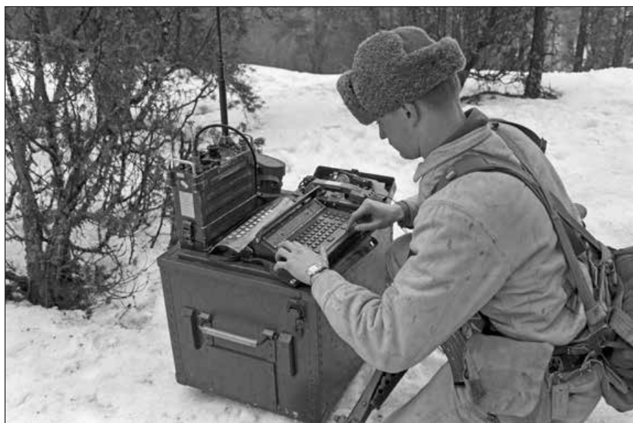
M90-sanomalaite liitettynä LV217 kenttäradioon. Taustalla P78-kenttäpuhelin.
