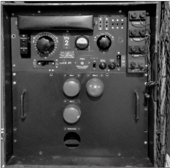
Saksalaista Tfb-kantoaaltolaitetta käytettiin runsaasti. Sen yhteysetäisyys kuparijohtoa käyttäen oli pienimmällä kantoaaltotaajuudella 500 km.
