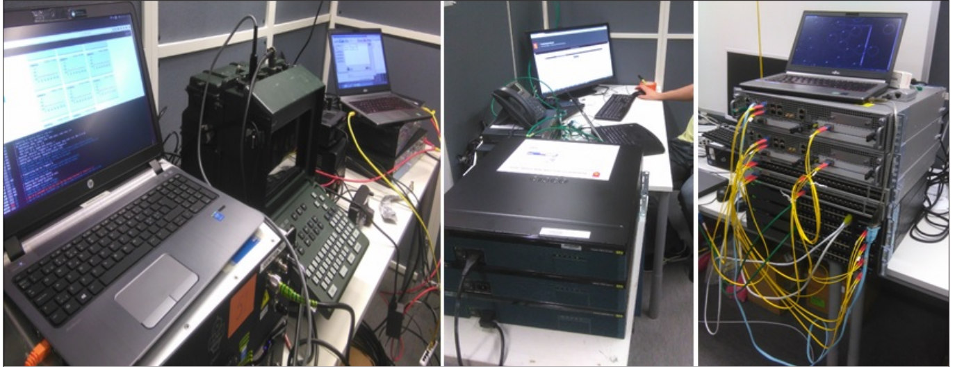
Keskellä liityntäreitittimen konfigurointiasema 'Tehdas' ja laidoilla sanomavälitystesteihin liittyvää testauskalustoa.
