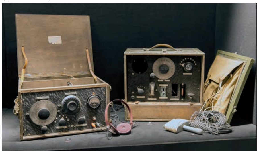
Perusnäyttelyn toisen kerroksen vitriinissä on näytteillä Suomalainen kenttäradio P-12-9. Radio oli tarkoitettu pataljoonaportaan yhteyksiin. Radion lähetysteho oli 1 W ja kantama noin 25 km. Radioita on valmistettu vuodesta 1926 alkaen ja niitä oli käytössä vielä jatkosodan alkaessa.
