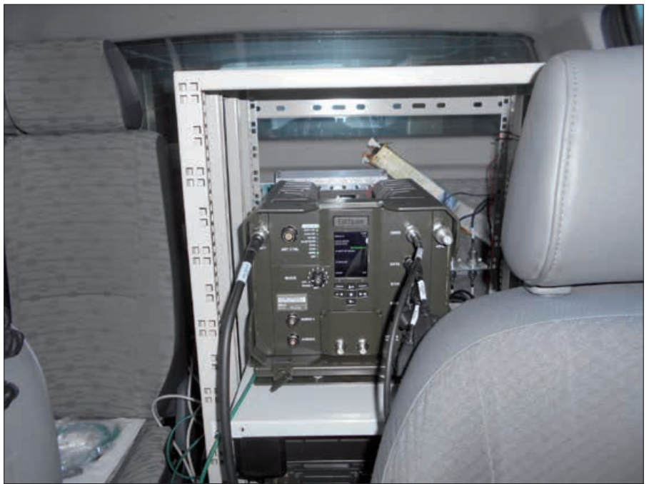
Tough SDR-Ajoneuvoradio asennettuna liikkuvaan integraatiotestiympäristöön.
